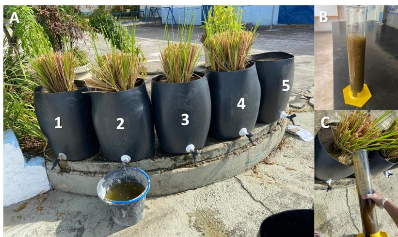
**Figura 2.** Remoção das amostras nos Sistemas de Wetlands Construídas (A); efluente bruto (B); aplicação do efluente bruto nas Wetlands (C)
