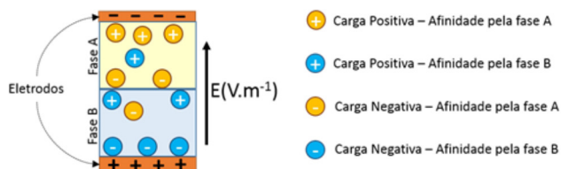
Figura 3. Diagrama da eletroforese bifásica. As moléculas são separadas de acordo com sua carga e a sua afinidade pelas fases presentes no sistema
