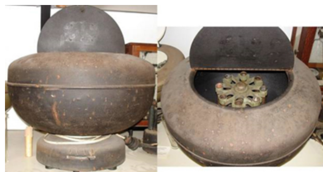
Figura 7. Centrífuga de origem americana, fabricada em 1952, feita em ferro fundido. A centrífuga tem controle para 3 velocidades pode atingir até 3500 rpm, com capacidade de 8 tubos. Sua massa elevada (45 kg), visava reduzir o deslocamento pela bancada quando a centrífuga era empregada em altas rotações. Nota-se também um grande espaço interno, como fator de proteção caso algum tubo se quebrasse. Acervo do Museu da Química Professor Athos da Silveira Ramos
