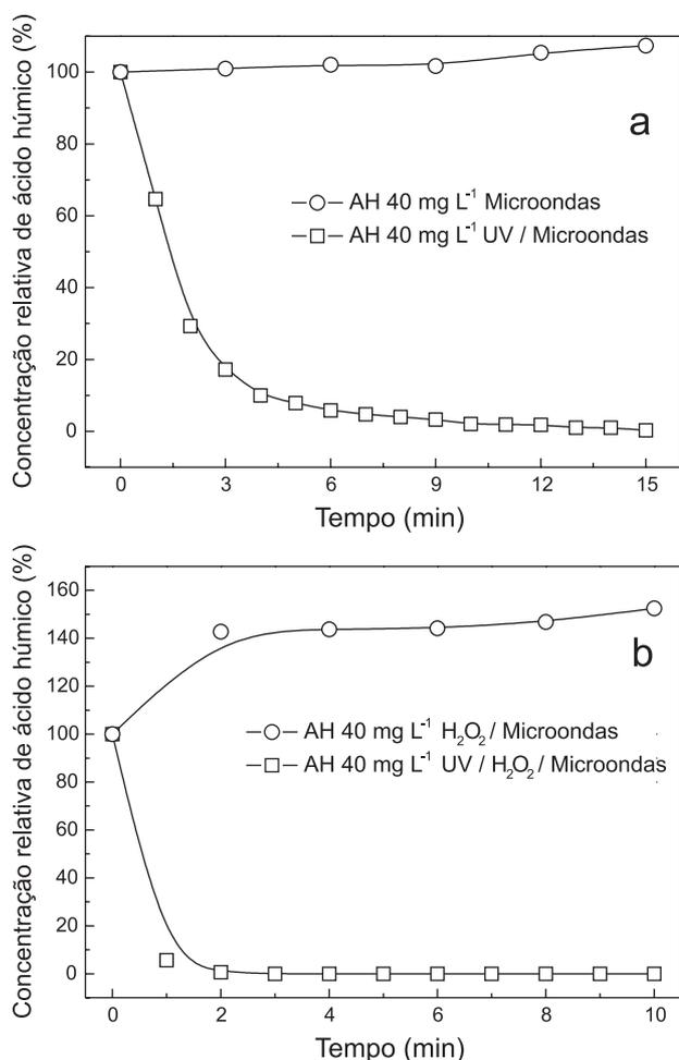
**Figura 3.** Concentração relativa de ácido húmico expressa como porcentagem do sinal de emissão de fluorescência em 440 nm ( $\lambda_{exc} = 315$  nm). (a) AH 40 mg L<sup>-1</sup> e (b) AH 40 mg L<sup>-1</sup> na presença de 12 μL de H<sub>2</sub>O<sub>2</sub>. Amostras processadas em um tubo de ensaio de borossilicato (○) e no reator fotoquímico ativado por microondas (□)
