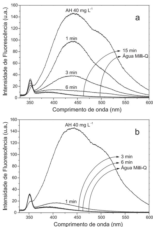
**Figura 2.** Espectros de emissão de fluorescência para uma solução  $40 \text{ mg L}^{-1}$  de ácido húmico na ausência (a) e na presença (b) de  $\text{H}_2\text{O}_2$  em diferentes tempos de irradiação
