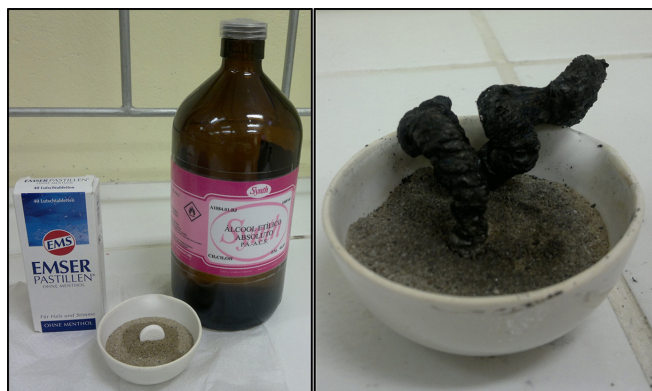
Figura 3. Preparação de “Serpente (não-peçonhenta) de Faraó” com Pastilhas de Ems
