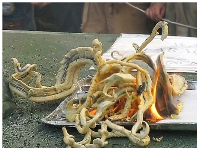
Figura 1. “Serpentes de Faraó” formadas pela decomposição de Tiocianato de Mercúrio(II) 2
