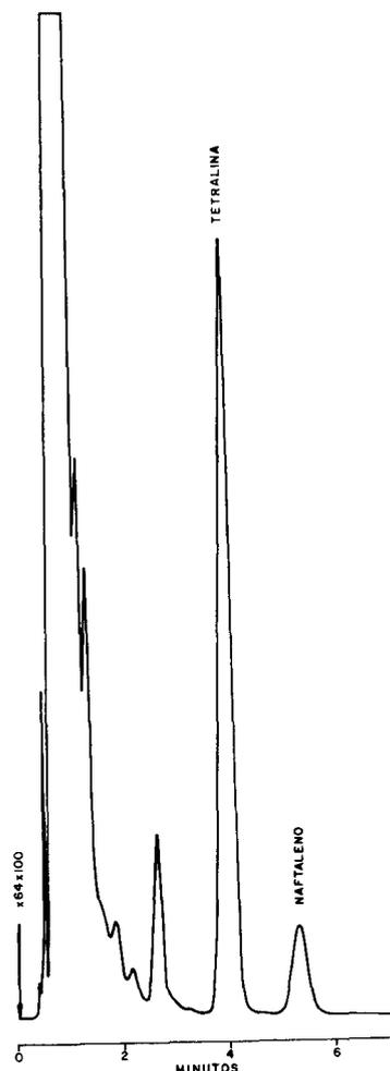
Fig. 2— Análise cromatográfica de naftaleno absorvido em benzeno. Condições de operação conforme descritas na tabela I.
