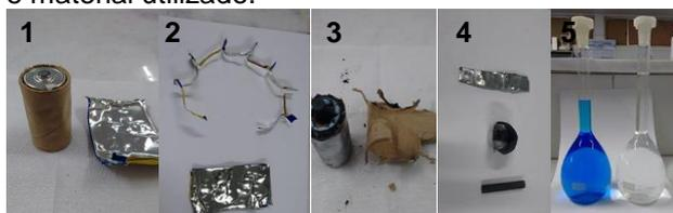
A maior parte da pilha foi utilizada na montagem da pilha de Daniell, acrescentado apenas uma solução de sulfato de cobre e outra de sulfato de zinco 1,0 mol.L<sup>-1</sup>. A solução de sulfato zinco pode ser feita a partir do zinco que contém na pilha, adicionando ácido sulfúrico de forma estequiométrica, o teste com essa solução foi feito, mas a solução apresentou impureza de outros metais diminuindo a tensão esperada.
