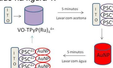
Figura 1. Esquema para a obtenção do eletrodo de ITO modificado.
