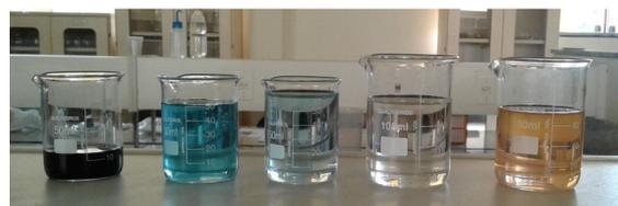
Figura 2. Separação dos corantes após a saída da coluna cromatográfica. Da esquerda para a direita, a mistura dos corantes, em seguida as soluções eluídas de Índigo de Carmina, solvente e Vermelho Congo.
