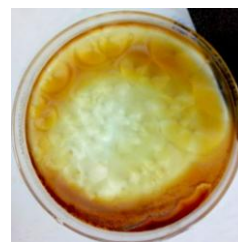
Figura 1: Formação do óxido de ferro no filme de PVP após o aquecimento.
