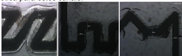
Figura 1. Microscopia dos microcanais fabricados.
