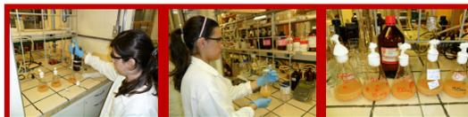
Figura 2. Coleta de alíquotas, extração líquido-líquido e frascos com bioreduções
