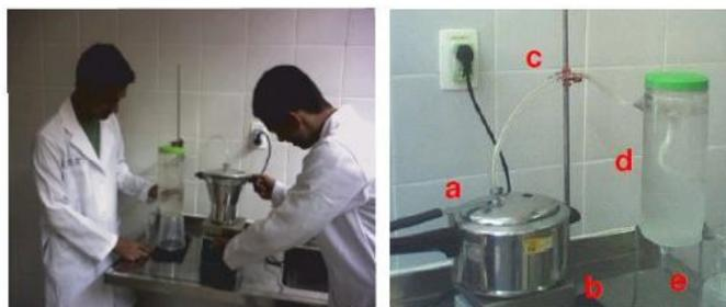
Figura 1. Confeção do hidrodestilador caseiro (a); processo de hidrodestilação acontecendo (b).
