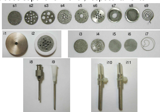
Figura 1. Eletrodos superiores ("s") e inferiores ("i").
