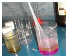
Figura 1. Fio de náilon 6,6 puxado da interface.
