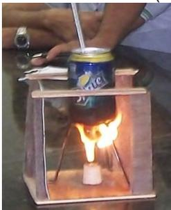
Figura 1. *Calorímetro Alternativo*.
