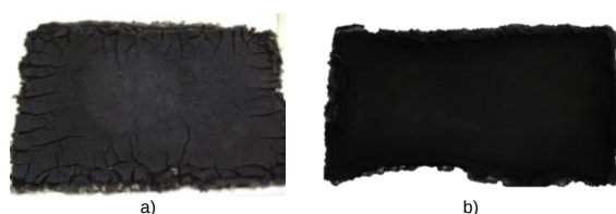
Figura 1. Fotografia da Blenda de Silicona/PANi(ADBS) 85/15 a) obtida à temperatura ambiente b) obtida com temperatura de -2°C.
