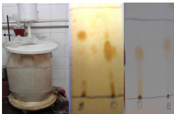
Fig. 1. a) Reator artesanal; b) CCD da reação em reator; c) CCD da reação em bancada.
