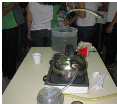
Figura 1 – Extração do óleo essencial da pimenta do reino com materiais do cotidiano.
