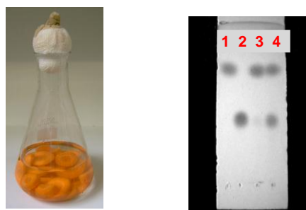
Figura 1. Montagem do experimento e análise de CCD revelada na lâmpada UV. 1: Material de partida; 2: Produto padrão; 3: reação biocatalisada após 3 horas; 4: Reação após 24 horas.
