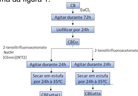
Figura 1- Fluxograma da preparação das membranas CBEu, CBEutta, CBEuttaLI.
