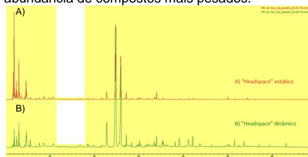
Figura 1. Cromatogramas (TIC): A) HS-MEFS estático e B) HS-MEFS dinâmico.
