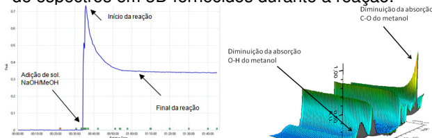
Figura 3. (a) Monitoramento do consumo do metanol pela absorção da ligação \text{sp}^3\text{C-O} do metanol (b) Espectros em 3D fornecido durante a reação, destacando a diminuição das absorções das ligações O-H e \text{sp}^3\text{C-O} pelo consumo do metanol.
