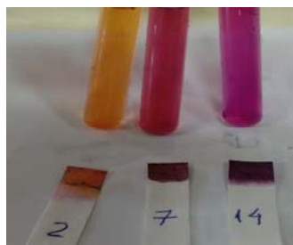
Figura 1. Corante de cochonilha em pH 2,0, 7,0 e 14 em tubos de ensaio e em papel de filtro como indicador
