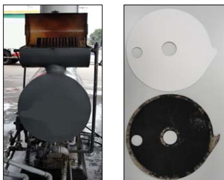
Figura 1. Sistema de filtragem e elementos filtrantes da bomba.
