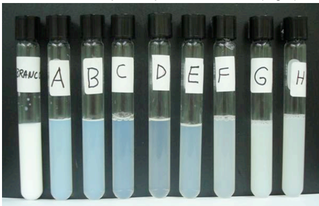
Figura 2. Emulsões com diferentes concentrações de miltefosine, em mg/mL: 0 (Branco); 0,07 (A); 0,10 (B); 0,15 (C); 0,20 (D); 0,25 (E); 0,30 (F); 0,35 (G) e 0,40 mg/mL (H).
