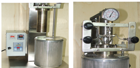
Figura 1 - Reator de aço inox utilizado no trabalho para produção de éteres alquílicos de glicerol.
