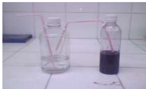
Figura 1. Esquema para a montagem do sistema de simulação do bafômetro.
