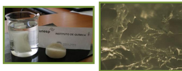
Figura 3. Material poroso obtido com a liofilização do hidrogel de fibroína (esq.) e respectiva microscopia (dir.).
