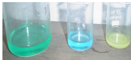
Figura 1. Aspecto do lixiviado ácido das fitas (esquerda), e das fases aquosa (centro) e orgânica (direita) após a extração do ouro com metil-isobutilcetona.
