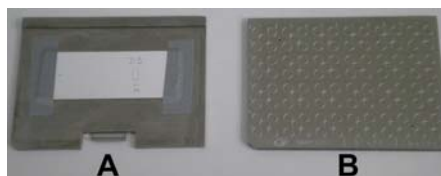
Figura 2. A) Placa de TLC adaptada a uma placa de MALDI DIOS. B) Placa de MALDI convencional de 96 spots.
