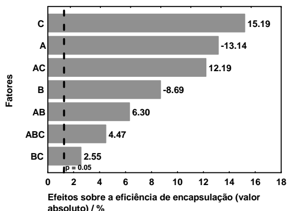
Figura 1. Efeito dos parâmetros A, B e C sobre a eficiência de encapsulação do InPc.
