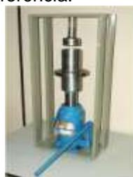
Figura 1- Prensa pistão-cilindro com acionamento hidráulico
