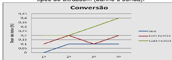
Figura 2. Teor de éster produzido pelos catalisadores  $\text{CoFe}_2\text{O}_4$  e  $\text{Fe}_3\text{O}_4$ .
