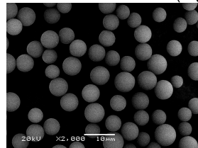
Figura 1. Micrografias das partículas de sílica-zircônia/titânia, ampliação 2000 vezes.
