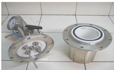
Figura 1. Reator utilizado na síntese da glicina
