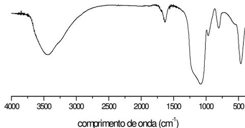
Figura 1. Espectros de absorção na região do IV para a sílica mesoporosa SBA-16
