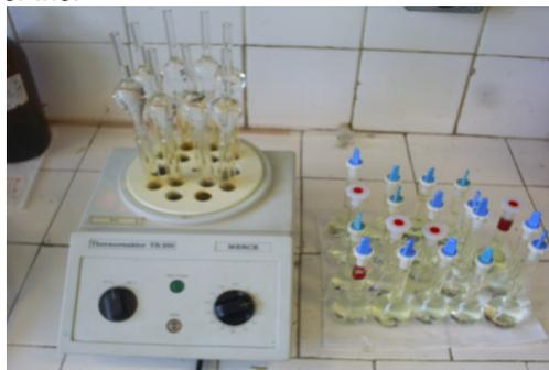
Figura 1. Sistema do bloco digestor
