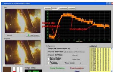
Figura 1: Tela do programa MV durante a precipitação do  $\text{BaSO}_4$ .
