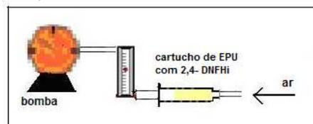
Figura 1. Esquema da amostragem de CC no ar.
