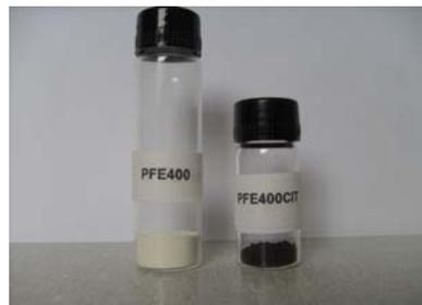
Figura 3.  $LiFeP_2O_7$  sem citrato (PFE400) e  $LiFeP_2O_7$  com citrato (PFE400CIT) calcinados à 400°C.
