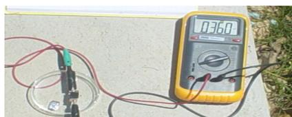
Figura 2. Célula solar de TiO<sub>2</sub>-corante de Hibisco em funcionamento
