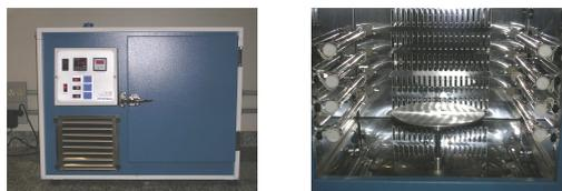
Figura 1. Câmara de irradiação utilizada nos experimentos de fotodegradação.
