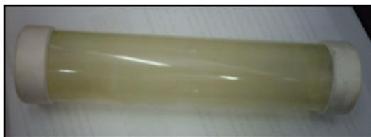
Figura 1. Reator tubular impregnado com  $\text{TiO}_2/\text{HPA}$
