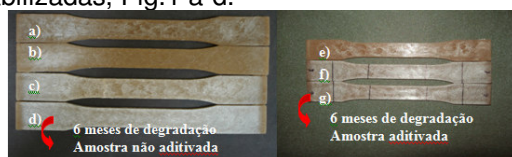
Figura 1: Amostras expostas ao envelhecimento ambiental: 78 % HDPE/ 20 % FC/ 2% PE-g-AM nos períodos de a) controle, b) 0 dias, c) 90 dias, d) 180 dias; 80% HDPE/ 20% FC em e) controle, f) 180 dias; e 77.9 HDPE/ 20% FC/ 2% PE-g-AM/ 0.1 % aditivos em g) 180 dias.
