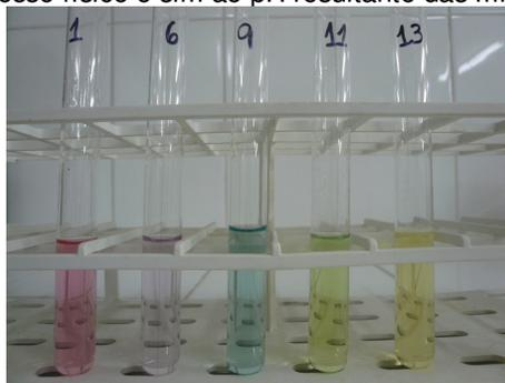
Figura 1- Cores das soluções com indicador repolho roxo em diferentes valores de pH.
