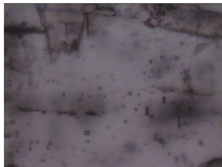
Figura 1. Inclusões bifásicas em plagioclásio ~ 6µm.
