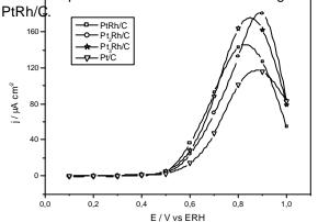
Figura 1: Curvas de polarização de estado estacionário para a eletrooxidação de etanol sobre Pt/C,  $Pt_3Rh/C$ ,  $Pt_2Rh/C$  e PtRh/C em soluções aquosas  $H_2SO_4$  0,5 mol  $L^{-1}$  contendo  $CH_3CH_2OH$  0,5 mol  $L^{-1}$  saturadas com  $N_2$ .
