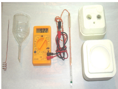
Figura 1- Calorímetro: agitador, funil, multímetro, termistor e vaso calorimétrico
