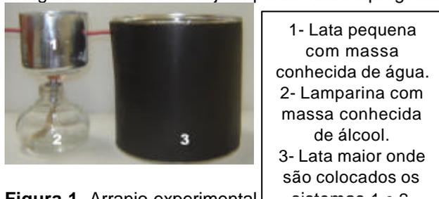
Figura 1. Arranjo experimental para determinação do calor de combustão
